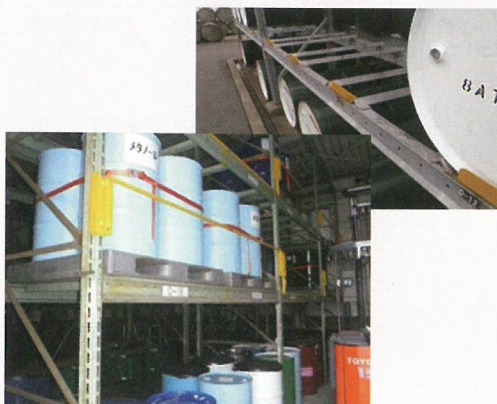
2011年3月7日に設置が完了し、震災による被害を防いだ耐震ラック
