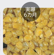
エポキシ系 自然石舗装材の黄変
